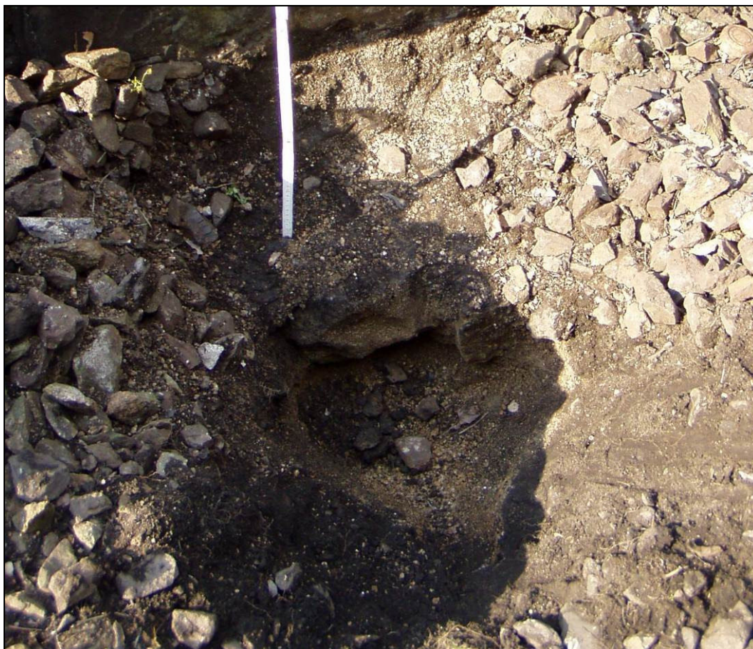
Obr. č. 11 Archivní kopaná sonda v km 0,350 pod patou OZ
