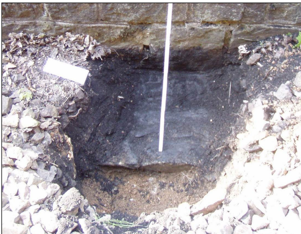
Obr. č. 12 Archivní kopaná sonda v km 0,500 pod patou OZ
