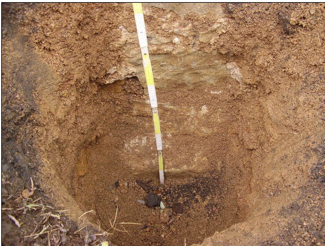
Obr. č. 7 Archivní kopaná sonda v km 0,600 nad korunou OZ
